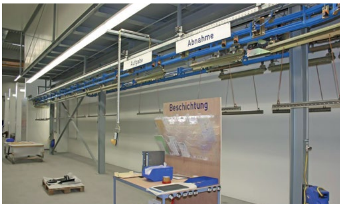
Logistique de transport de pièces à travers toutes les opérations de peinture.
