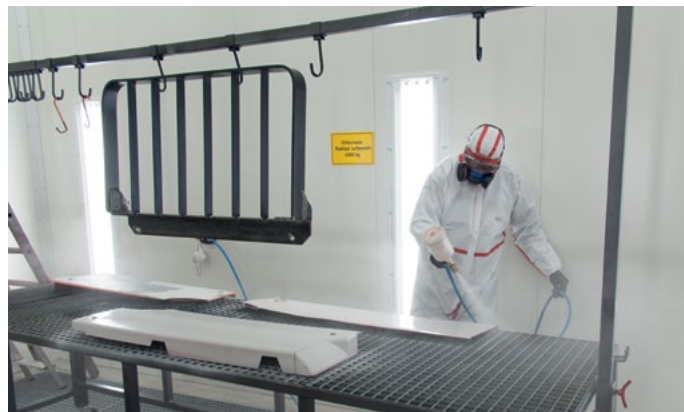
Et le plus important .... Les overspray et les solvants sont aspirés, et la qualité de surface est bonne!
