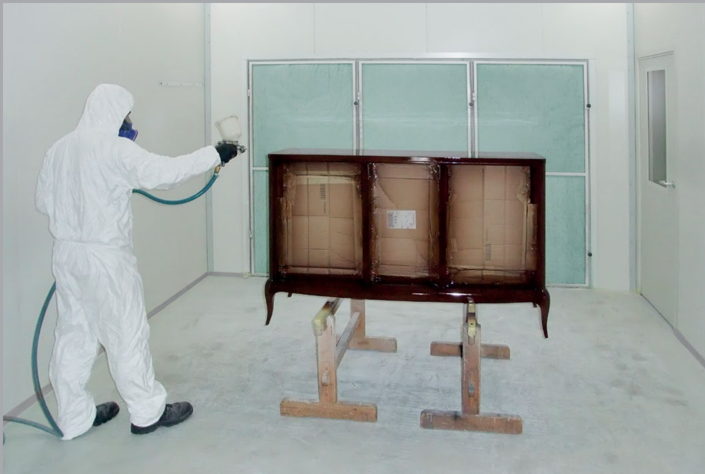
Cabine de peinture compacte avec fonction de séchage intégrée dans un atelier de menuiserie moderne.
