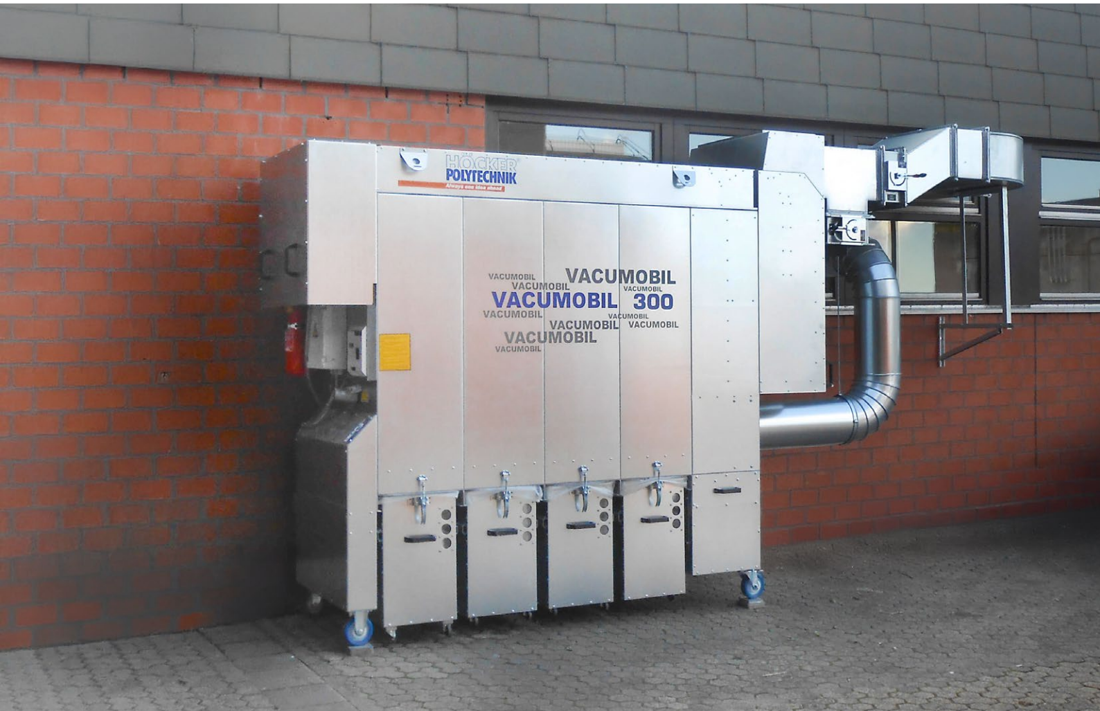
Vacumobil JT 300 dans le traitement du bois comme installation extérieure avec air de retour et évacuation dans des tonneaux à copeaux.
