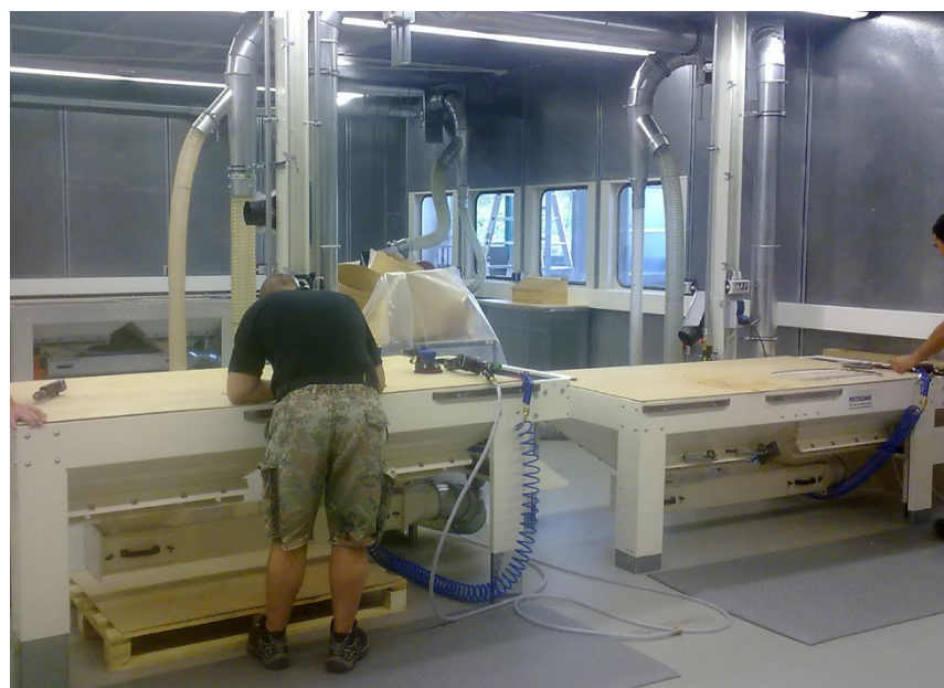
Deux tables aspirantes Expert Z 20 pour l'aspiration des poussières d'égrénage de peinture
