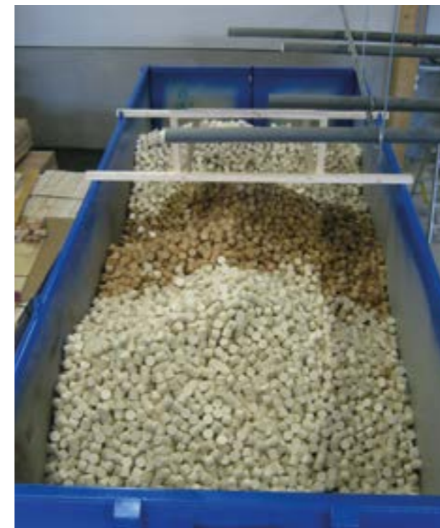
Les quatre presses à briquettes BrikStar V 11 produisent 700 kg/h de briquettes de haute qualité.
