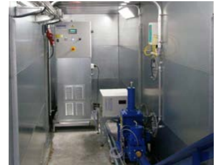
Un modèle BrikStar V dans une solution combinée avec un conteneur à fond mouvant et un système de filtration MultiStar. L'installation dans une cabine pour la protection contre les intempéries permet un accès confortable. Avec refroidissement par eau de la pince pour un fonctionnement continu.
