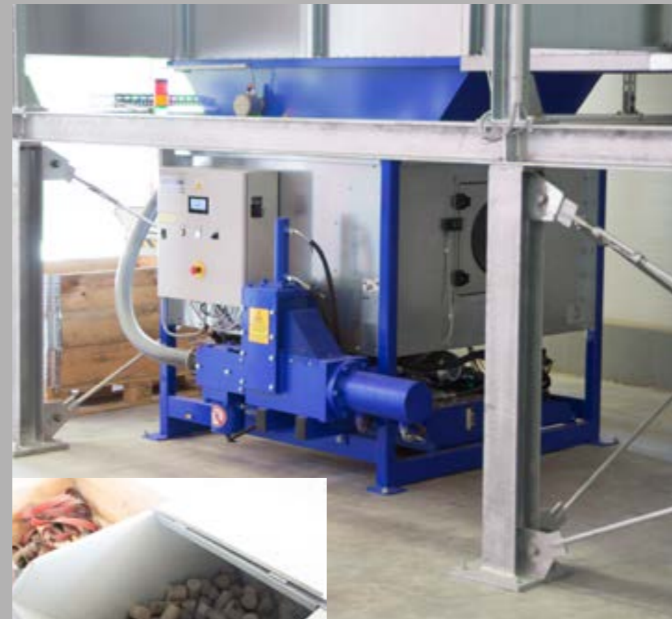
Système de filtration MultiStar avec presse à briquettes BrikStar C chez un fabricant d'emballage en carton ondulé.
