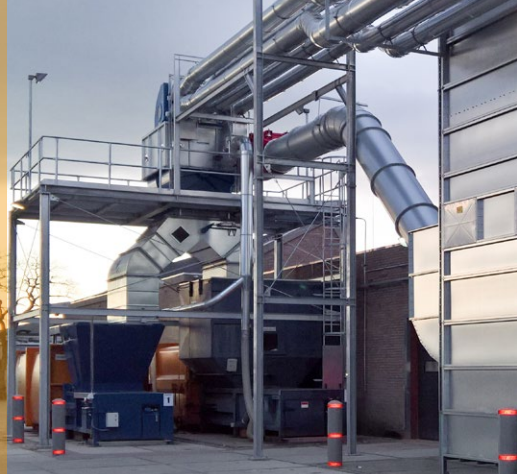
Séparateur de matière PMA-U dans la fabrication de boîtes pliables.
