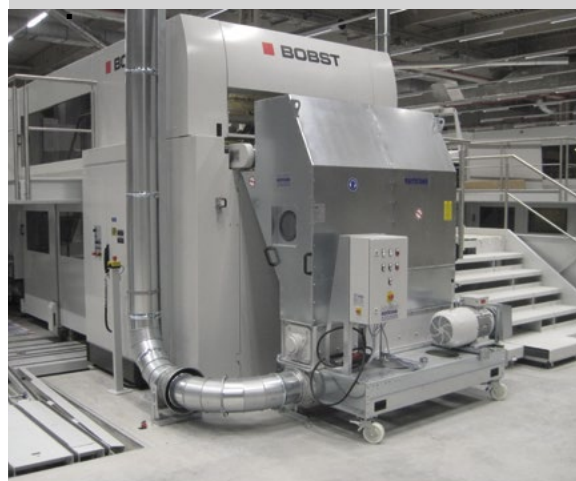
Broyeur PHSS-K/G Broyeur de grilles de découpe et de bords de préhension avec station d'accueil
