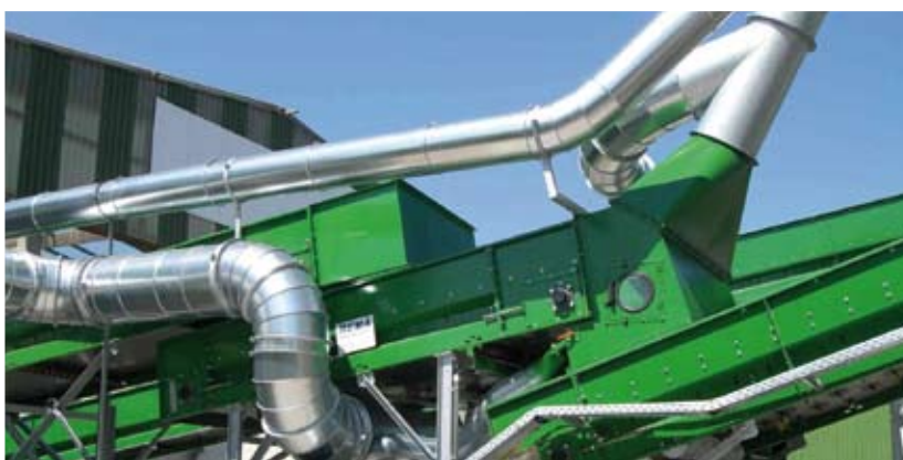
Windsichter von HÖCKER POLYTECHNIK / Système de tri aéraulique de HÖCKER POLYTECHNIK
